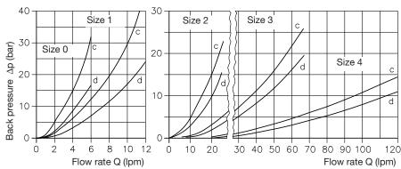
Curve c:  $P \rightarrow A(B)$  Curve d:  $A(B) \rightarrow R$
